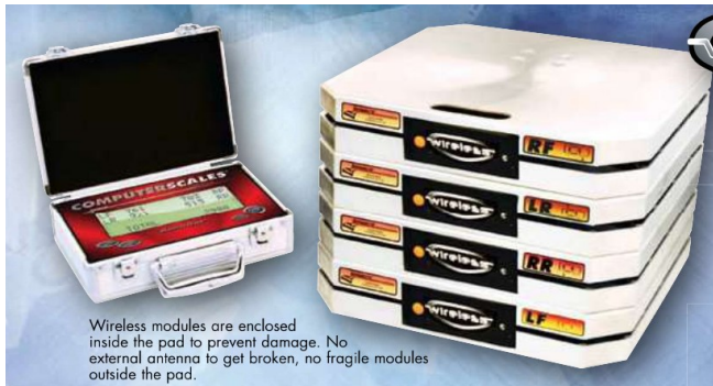
Weegschalen set, draadloos met certificaat. In koffer met oprij-ramps en slip plate voor zijwaardse krachen
