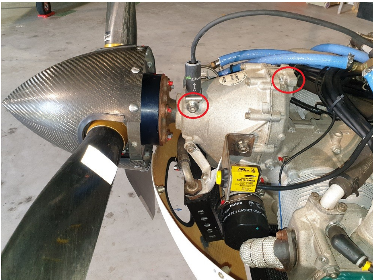
Harde montagepunten voor de trillingsensor op een Rotax 912
